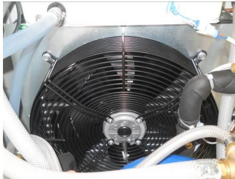
Picture 18 – Fan placement
